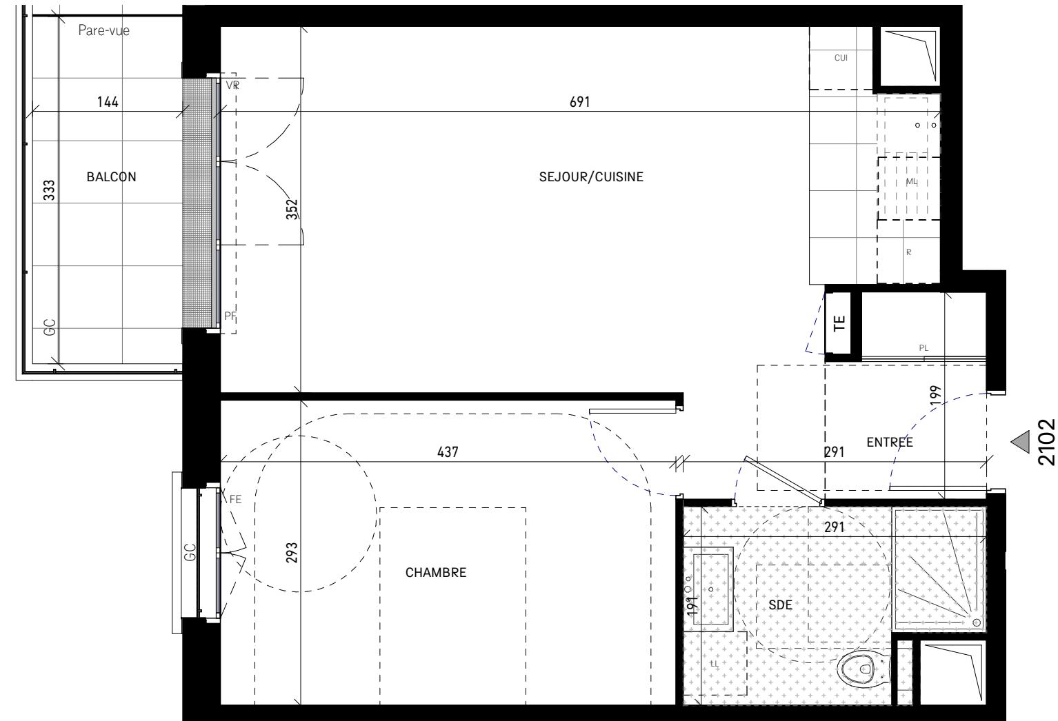
LEGENDE: PF: Porte Fenêtre / FE: Fenêtre / FAB: Fenêtre Allège basse / VR: Volet roulant / GC: Garde-corps / PL: Placard / CUI: Cuisson / R: Réfrigérateur / LL: Lave Linge / LV: Lave Vaisselle / TE: Tableau électrique / SS: Sèche - Serviettes / Soffite, faux-plafonds: / Niveau: 0.00
