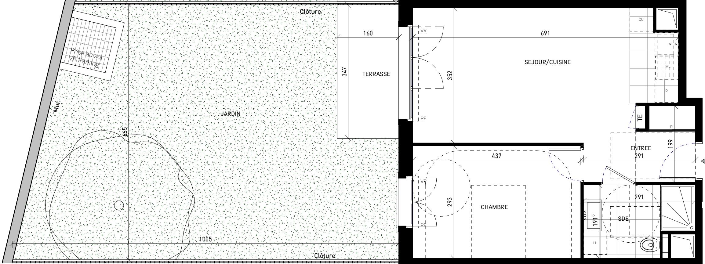
LEGENDE: PF: Porte Fenêtre / FE: Fenêtre / FAB: Fenêtre Allège basse / VR: Volet roulant / GC: Garde-corps / PL: Placard / CUI: Cuisson / R: Réfrigérateur / LL: Lave Linge / LV: Lave Vaisselle / TE: Tableau électrique / SS: Sèche - Serviettes / Soffite, faux-plafonds: / Niveau: 0.00
