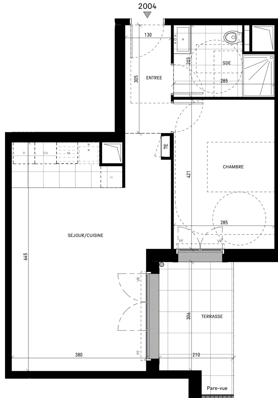
LEGENDE: PF: Porte Fenêtre / FE: Fenêtre / FAB: Fenêtre Allège basse / VR: Volet roulant / GC: Garde-corps / PL: Placard / CUI: Cuisson / R: Réfrigérateur / LL: Lave Linge / LV: Lave Vaisselle / TE: Tableau électrique / SS: Sèche - Serviettes / Soffite, faux-plafonds: [ ] / Niveau: 0.00
